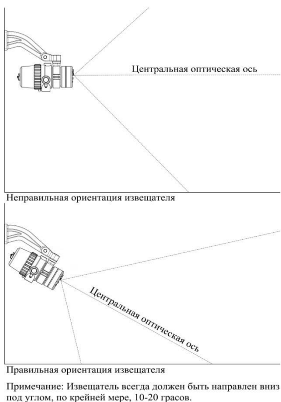
Рисунок 6 – Установка извещателя по отношению к горизонту.
