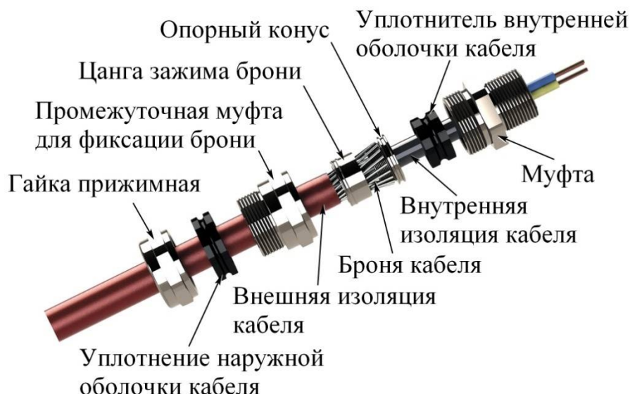
Рисунок 8 – Пример монтажа кабельного ввода
