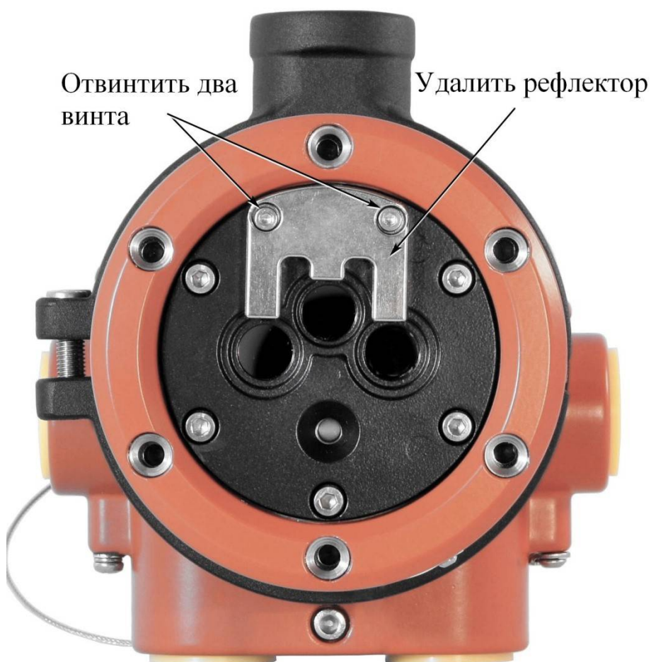
Рисунок 19 - Снятие рефлектора ОН.
