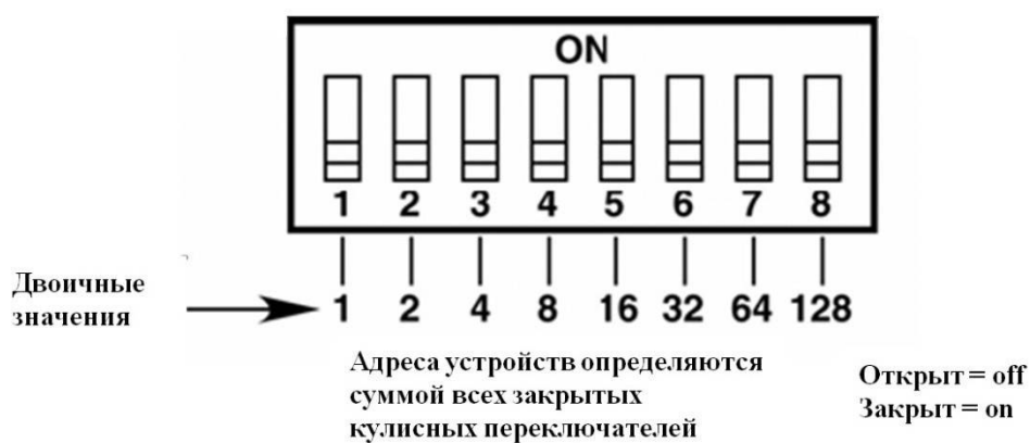
Рисунок 18 – Адресные переключатели извещателя
